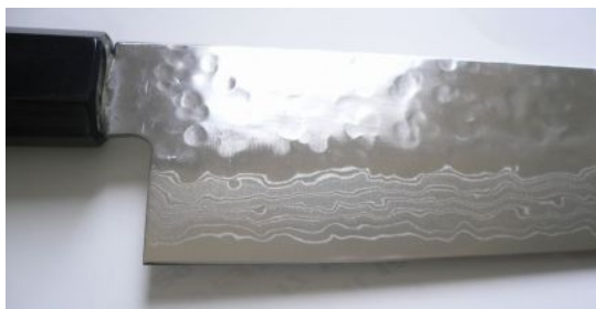
ステンニッケル積層 片面22層 刃材厚身:2.0mm HRC60 ±
