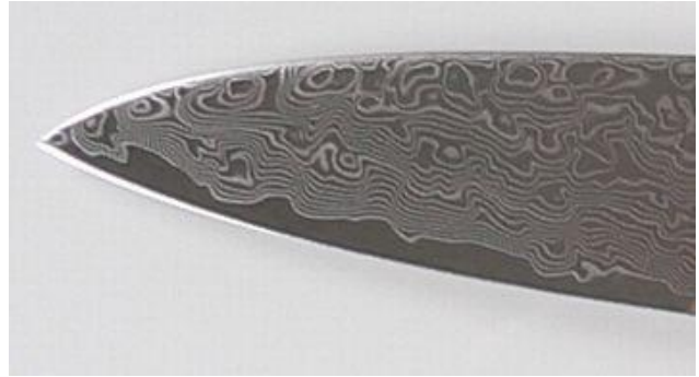
101層 (片面50層) ステン + ニッケル積層鋼 : 刃材V金10号ステンレス鋼
